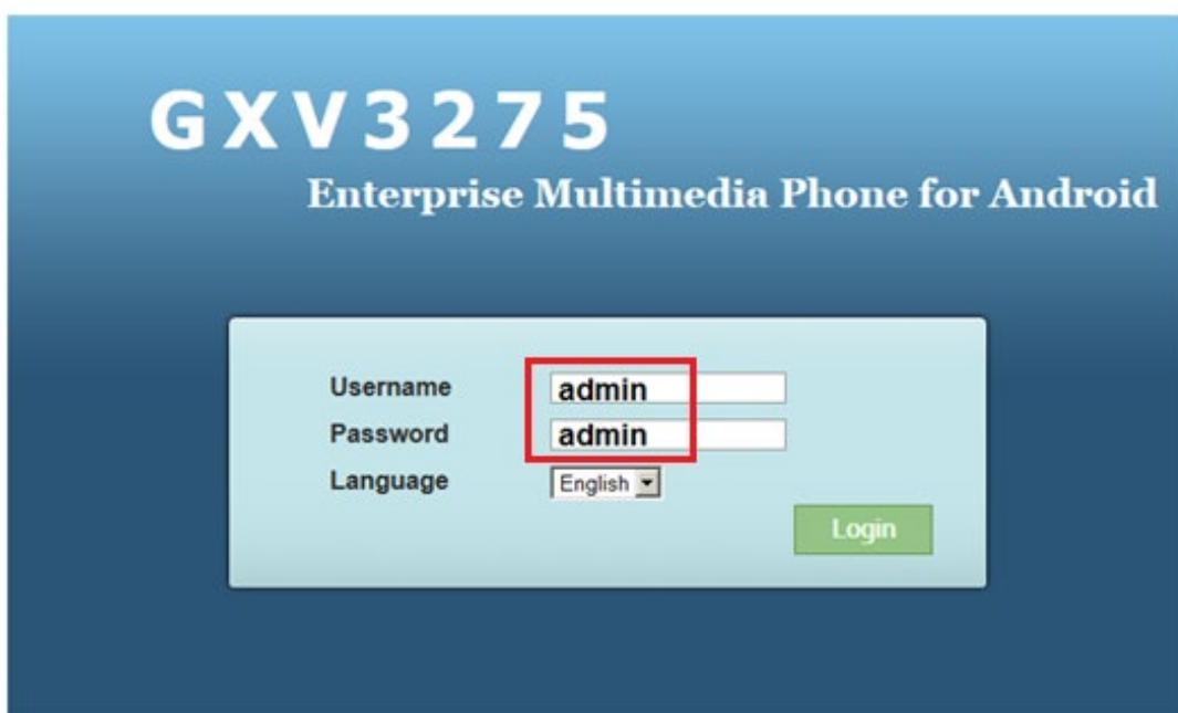
3. Vor der ersten Inbetriebnahme des GXV 3275 muss das Betriebssystem/Firmware aktualisiert werden. Gehen Sie wie folgt vor. Im Fenster Maintenance – Upgrade tragen Sie folgende Daten ein.
